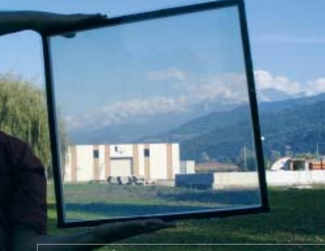
El doble cristal relleno con un aerogel impide las pérdidas de calor.
