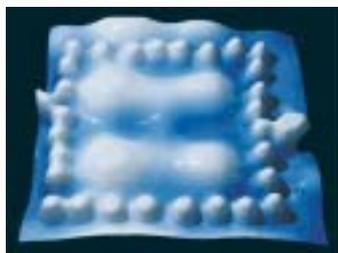
Átomos de manganeso sobre plata en la Universidad Christian-Albrechts de Kiel. Los electrones cercados por una valla de átomos de manganeso forman modelos de distribución que dependen del voltaje eléctrico aplicado. Efectos como éste serán importantes para la electrónica del mañana.
