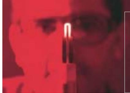
He aquí algo que ni siquiera la naturaleza puede hacer: cerámica tratada con nano-hollín para sistemas de ignición por incandescencia resistentes a la corrosión, por ejemplo para calentadores de gas. La conductividad ajustable de la cerámica evita la necesidad de un transformador.
