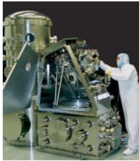
Prototipo de un waferstepper de EUV para la producción de generaciones futuras de microprocesadores.
