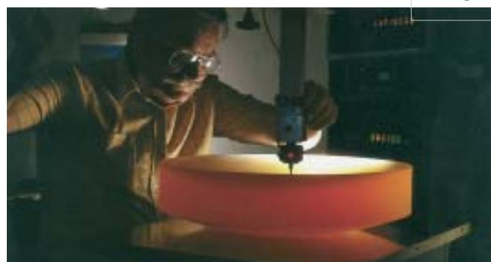
Imprimiendo el nanocosmos: En el Institut für Halbleitertechnik (IHT) de la Universidad RWTH-Aachen, se consiguen ya estructuras de microprocesador de 80 nanómetros de ancho con la ayuda de métodos mecánicos/ópticos. Aplicaciones: circuitos de gran complejidad en pequeñas series.
