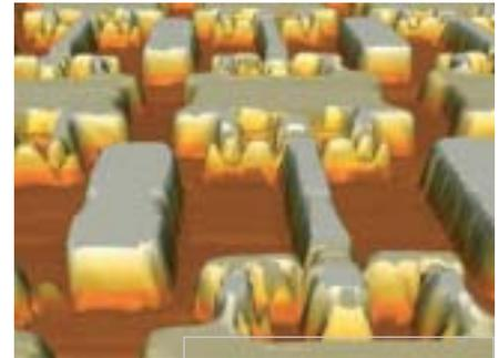
Las sondas "capacitivas" permiten representar los procesos de conmutación que se dan en un chip.
