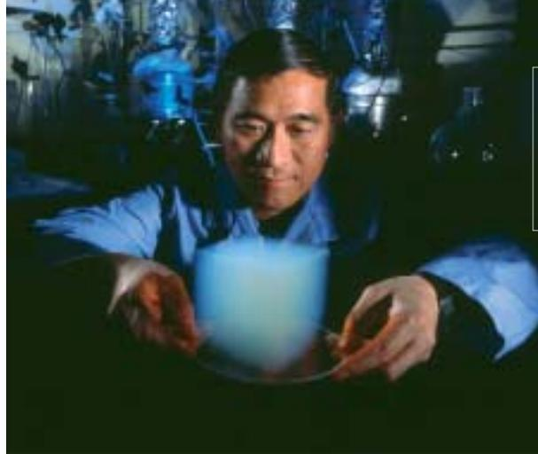
Un aerogel que sirve para atrapar el polvo con fines científicos. Las partículas quedan atrapadas firmemente en un compuesto de aerogel fundido.
