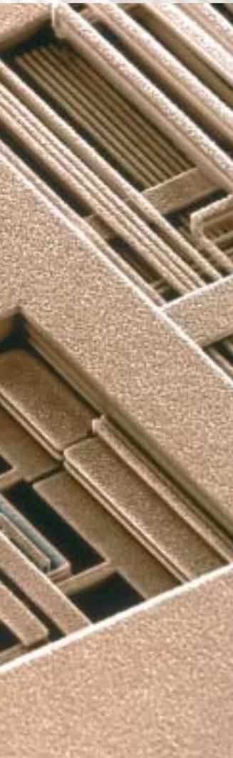
Tan complejo como una ciudad: los circuitos de cobre de un microprocesador (IBM), vistos con un microscopio electrónico de barrido. Los microprocesadores modernos tienen hasta nueve niveles de circuitos.
