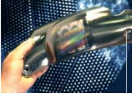
El Institut für Neue Materialien (INM) de Saarbrücken ha desarrollado procesos a base de nanopartículas para aplicar a los componentes de metal hologramas no falsificables y resistentes al desgaste.
