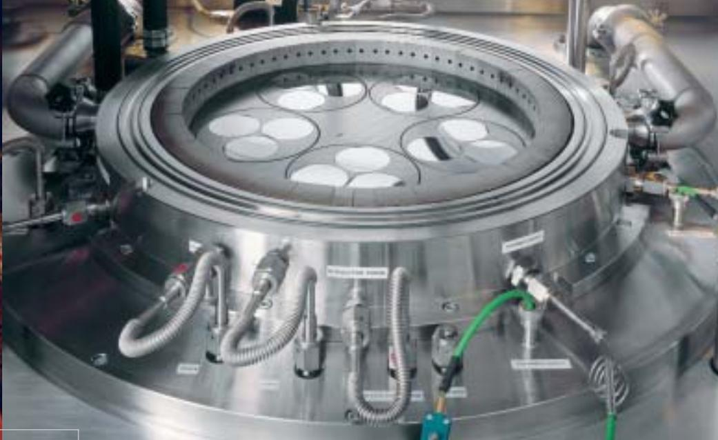
Reactores Aixtron para la investigación (izquierda) y para la producción de capas finas de semiconductores conectores con una precisión atómica (derecha).
