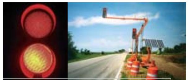
Diodos emisores de luz (LED) en los semáforos ahorran tiempo de servicio y energía. La amortización no es superior a un año.
