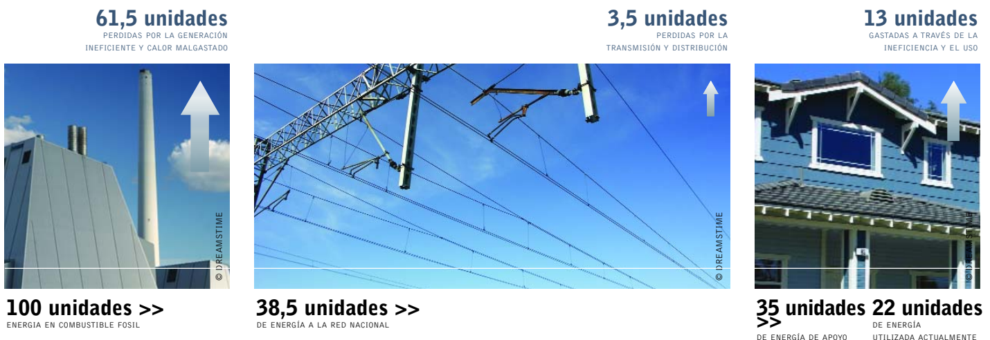
figura 6: las infraestructuras energéticas centralizadas derrochan más de dos tercios de su energía
