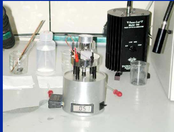
Microscópio de Barrido Tunnel (STM) es una técnica microscópica que permite la investigación de superficies conductoras de electricidad a nanoescala
