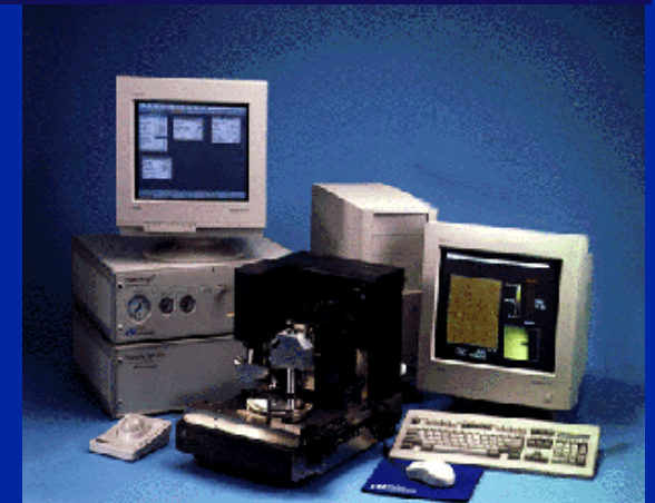
Microscópio de Fuerza Atómica (AFM), es particularmente útil para ver muestras biológicas.
